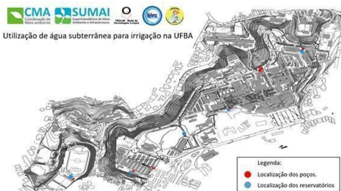
Figura 43: Mapa ilustrativo dos pontos de perfuração e instalação de Poços Subterrâneos. Fonte: Acervo CMA (2019).
